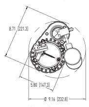
1/3 HP & 1/2 HP PUMP WITH VERTICAL SWITCH
